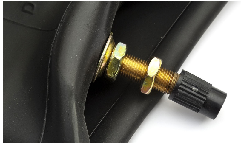
Ventiel van een binnenband - herkenbaar aan moer (of ring) buiten de velg
